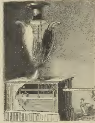
Fig. 2.—Otra vasija maravillosa de Heron. Cambiando de lugar una pesa, se puede hacer salir una cantidad determinada del líquido.
